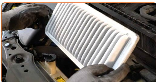
**11** Limpe a tampa do filtro de ar e a caixa. Use o spray de limpeza universal.
