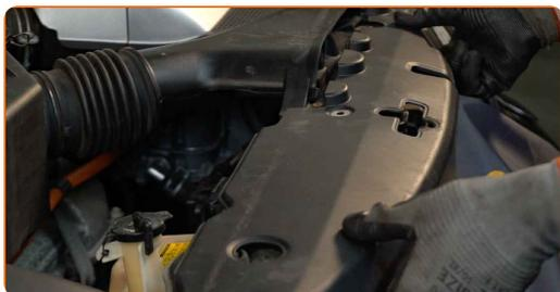
20 Instale os pinos de fixação da cobertura do suporte do radiador. Use uma ferramenta de remoção de clipe.
