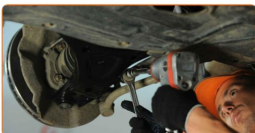
**13** Desaparafuse o fixador que conecta bieleta da barra estabilizadora à barra estabilizadora. Use uma chave combinada nº 17. Use uma chave soquete nº 17. Use uma chave de torque. Aperte-o para o torque de 65 Nm.
