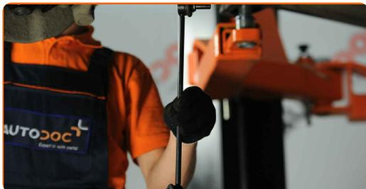
**12** Aperte o fixador que conecta a bieleta da barra estabilizadora à barra estabilizadora. Use uma chave combinada nº 17. Use uma chave soquete nº 17. Use uma chave de torque. Aperte-o para o torque de 65 Nm.
