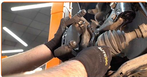
**25** Aperte a braçadeira da pinça do travão. Use uma chave combinada nº 17. Use uma chave soquete nº 17. Use uma chave de torque. Aperte-o para o torque de 85 Nm.
