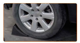
Solte os parafusos de montagem das rodas. Use o soquete de impacto para roda #21.
