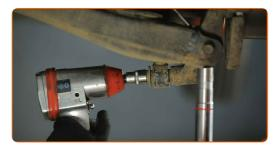
Desaperte a fixação superior do amortecedor. Use uma chave soquete nº 24. Use uma chave de catraca.
