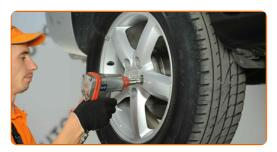
Baixar o carro e trabalhar em ordem transversal, apertar os parafusos das rodas. Use o soquete de impacto para roda #21. Use uma chave de torque. Aperte-o para o torque de 108 Nm.
