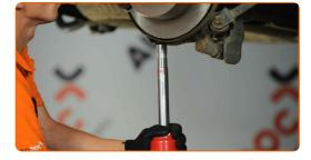
Desenrosque os elementos de fixação da cobertura do braço de suspensão. Use uma chave soquete nº 10. Use uma chave de catraca.
