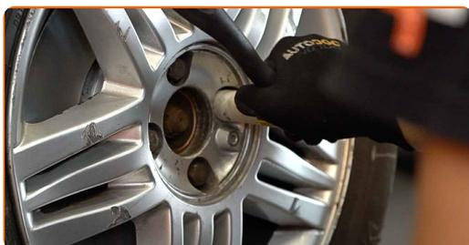
**32** Baixar o carro e trabalhar em ordem transversal, apertar os parafusos das rodas. Use uma chave de torque. Aperte-o para o torque de 110 Nm.
