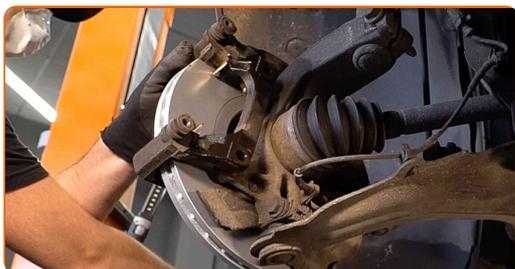
**23** Aperte a braçadeira da pinça do travão. Use uma chave soquete nº 18. Use uma chave de torque. Aperte-o para o torque de 105 Nm.
