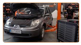
Desaperte os parafusos da roda.
