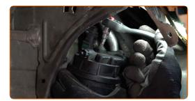
Desmonte a caixa do filtro de combustível montado com o cartucho do filtro antigo. Coloque o cartucho do filtro antigo no recipiente.
