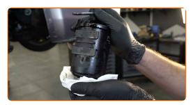
Instale a caixa do filtro de combustível montado com o cartucho do novo filtro.
