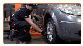
Eleve o automóvel utilizando um macaco ou coloque-o sobre um poço de inspeção.
