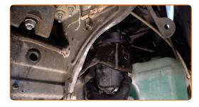
Instale a cobertura da cava da roda no seu local de montagem.
