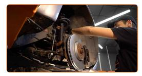
Instale e aperte os elementos de fixação da cobertura do arco da roda. Use Torx T25. Use uma chave de catraca.
