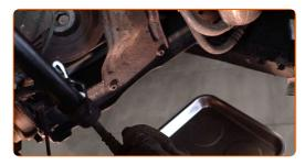
Desaperte os fixadores da tampa do filtro de combustível. Use Torx T30. Use uma chave de catraca.
