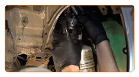
Aperte os fixadores da tampa do filtro de combustível. Use Torx T30. Use uma chave de torque. Aperte-o para o torque de 10 Nm.
