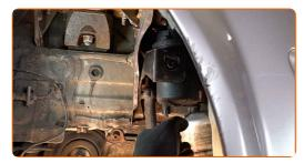
Desaperte os parafusos de fixação do suporte do filtro de combustível. Use uma chave soquete nº 10. Use uma chave de catraca.
