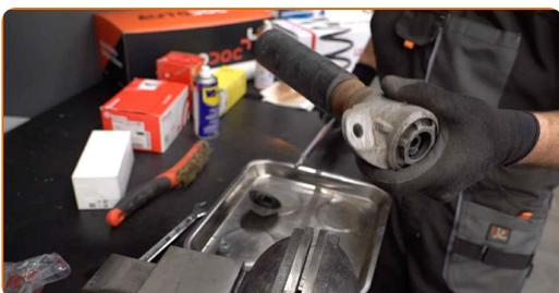
**17** Instale o novo suporte do amortecedor, o fole e o batente no amortecedor.
