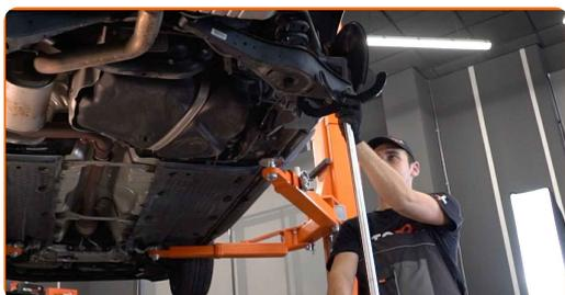
Substituição: cabeçotes do amortecedores – SEAT Alhambra (710, 711).
