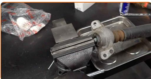
**15** Retire a fixação da haste do pistão do amortecedor. Use uma chave combinada nº 14.
