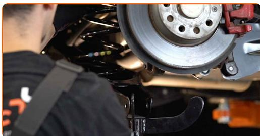
**26** Aperte os fixadores que conectam o braço de controlo à manga traseira. Use uma chave combinada nº 18. Use uma chave soquete nº 18. Use uma chave de torque. Aperte-o para o torque de 90 Nm.+90°
