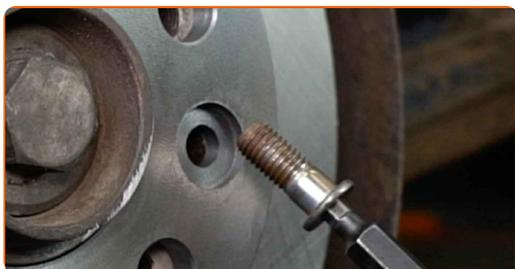
**28** Aperte a fixação do disco de travão. Use HEX n.º H6. Use uma chave de torque. Aperte-o para o torque de 10 Nm.
