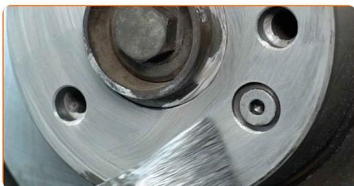
**44** Limpe a superfície do disco de travão. Utilize um produto de limpeza para travões.
