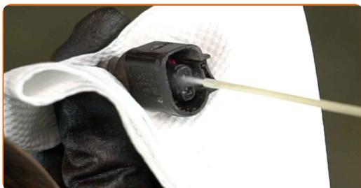
**41** Junte o conector do sensor de desgaste da pastilha de travão.
