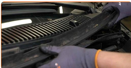
**4** Desenrosque os fixadores do painel de plástico. Use uma chave soquete nº 10. Use uma chave de catraca.
