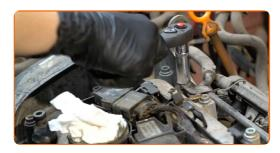
Retire a bobina de ignição do orifício da vela de ignição. Utilize um pé-de-cabra.
