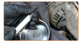
Aplique uma fina camada de lubrificante especial na superfície da rosca das novas velas de ignição. Use massa de cobre.
