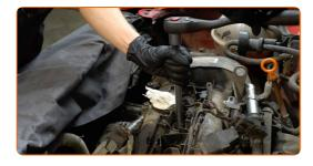
Retire as velas de ignição. Use o soquete da vela de ignição #16.
