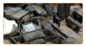
Desaperte os fixadores do terminal de ligação à terra das bobinas de ignição. Use uma chave soquete nº 10. Use uma chave de catraca.
