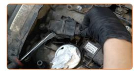
Substituição: vela de ignição – SEAT Alhambra (7V8, 7V9). Conselho da AUTODOC:
