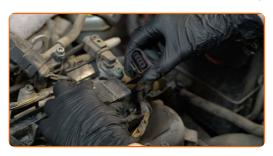
Limpe a sujidade, poeira e detritos de dentro dos poços das velas de ignição.
