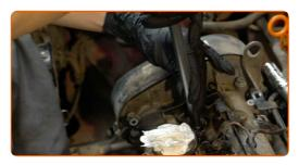
Aparafuse as novas velas de ignição e aperte-as. Use o soquete da vela de ignição #16. Use uma chave de torque. Aperte-o para o torque de 25 Nm.
