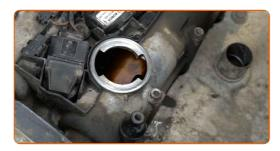
Instale o tubo de enchimento de óleo. Aperte o tubo de enchimento de óleo.
