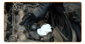
Aperte o terminal de ligação à terra das bobinas de ignição. Use uma chave soquete nº 10. Use uma chave de catraca.
