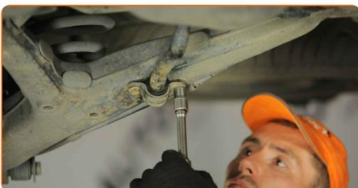
**12** Trate os fixadores dos suportes da bucha da barra estabilizadora. Use massa de cobre.
