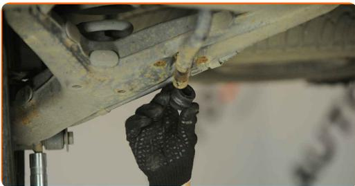
**9** Remova o apoio sob a viga do eixo traseiro.
