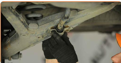
**11** Aperte os fixadores dos suportes da bucha da barra estabilizadora. Use uma chave soquete nº 13. Use uma chave de torque. Aperte-o para o torque de 35 Nm.
