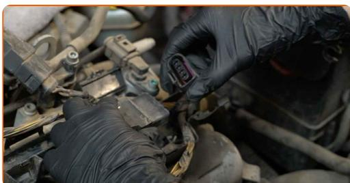
**8** Trate o conector da bobina de ignição com spray eletrónico. O spray protegerá os contactos elétricos contra a corrosão, oxidação e reduzirá a resistência do contacto.
