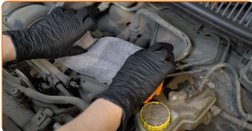
**6** Retire a bobina de ignição do orifício da vela de ignição. Utilize um pé-de-cabra.
