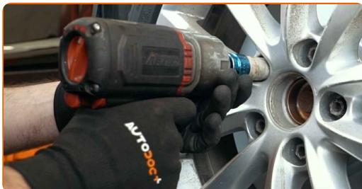
**21** Baixar o carro e trabalhar em ordem transversal, apertar os parafusos das rodas. Use o soquete de impacto para roda #17. Use uma chave de torque. Aperte-o para o torque de 120 Nm.
