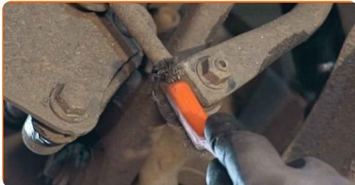
9 Desaparafuse o fixador que conecta a bieleta da barra estabilizadora à barra estabilizadora. Use uma chave combinada nº 16. Use XZN #6. Use uma chave de catraca.
