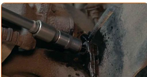
8 Limpe os elementos de fixação de conexão do estabilizador. Use uma escova metálica. Use spray WD-40.
