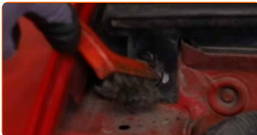
**4** Desenrosque os fixadores do painel de plástico. Use Torx T30. Use uma chave de catraca.
