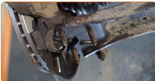
**57** Aparafuse o fixador que liga a junta esférica ao braço de controlo. Use uma chave soquete nº 16. Use uma chave de catraca.
