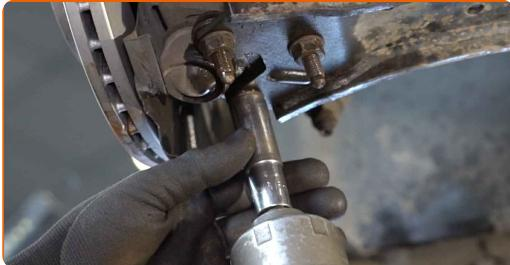
**58** Instale a aperte o parafuso do eixo de transmissão. Use uma chave soquete nº 27. Use uma chave de catraca.
