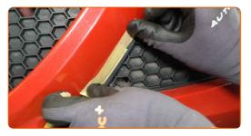
Desmonte a grelha do farol de nevoeiro. Utilize uma ferramenta de acabamento de plástico.
