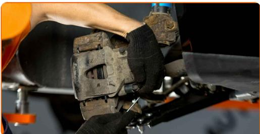
**11.1** Desaparafuse a fixação de pinça de travão.
