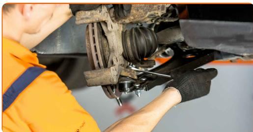
**50** Aperte o fixador da articulação esférica. Use uma chave combinada nº 19. Use uma chave de torque. Aperte-o para o torque de 60 Nm.
