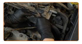
Instale as bobinas de ignição nos poços das velas de ignição. Certifique-se que ouve um clique a indicar que está fixa no local.
