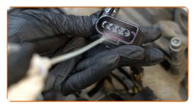
Ligue os conectores das bobinas de ignição.
