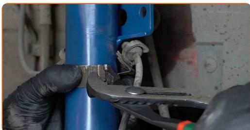
**68** Instale o terminal do estabilizador transversal.
