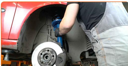
**50** Aparafuse a fixação superior de montagem do suporte do amortecedor Não o aperte.
