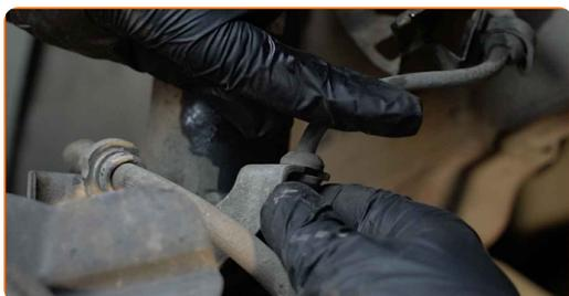
**19** Limpe os fixadores que conectam as colunas de suspensão às mangas de eixo. Use uma escova metálica. Use spray WD-40.
