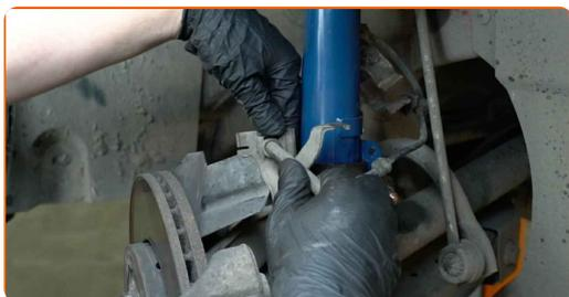
**67** Conecte os fios do sensor ABS. Use alicates de bomba de água.
