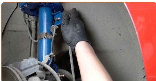
**69** Desaparafuse o fixador que conecta bieleta da barra estabilizadora à barra estabilizadora. Use uma chave soquete nº 17. Use uma chave de torque. Aperte-o para o torque de 40 Nm.
