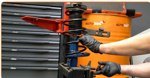
**48** Trate dos assentos de montagem do amortecedor. Use uma escova metálica. Use spray WD-40.
