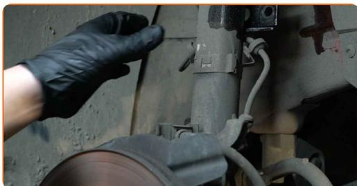
**15** Limpe o suporte da cablagem do ABS. Use uma escova metálica. Use spray WD-40.
