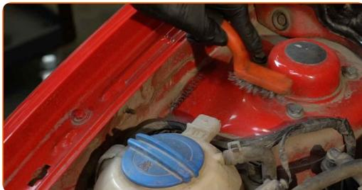
**4** Solte o fixador superior do apoio da coluna de suspensão. Use uma chave soquete nº 13. Use uma chave de catraca.
