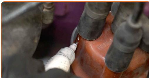
**4** Desconecte os cabos da vela de ignição da tampa do distribuidor.
