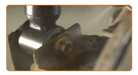
Limpe o local de montagem do aro do pneu. Use uma escova metálica.
