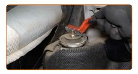
Solte o fixador superior do apoio da coluna de suspensão. Use uma chave combinada nº 17. Utilize a chave para amortecedor n.º DD5,2. Use uma chave de catraca.
