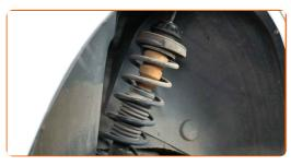
Coloque o suporte do amortecedor sobre a ferramenta de compressão da mola.
