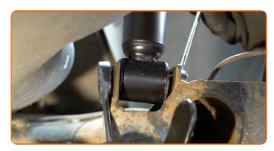
Aperte a fixação inferior do amortecedor. Use uma chave combinada nº 17. Use uma chave soquete nº 17. Use uma chave de torque. Aperte-o para o torque de 70 Nm.
