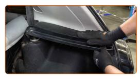
Aperte os fixadores do painel de acabamento plástico lateral. Use uma chave soquete nº 10. Use uma chave de catraca.
