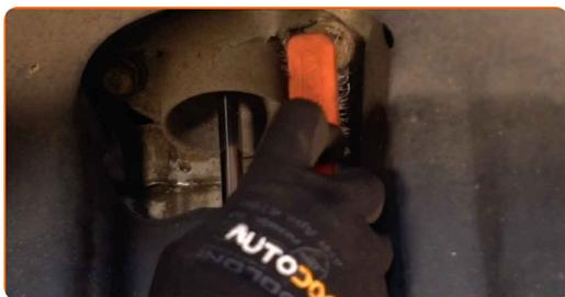
**7** Desaperte a fixação inferior do amortecedor. Use uma chave combinada nº 16. Use uma chave soquete nº 16. Use uma chave de catraca.
