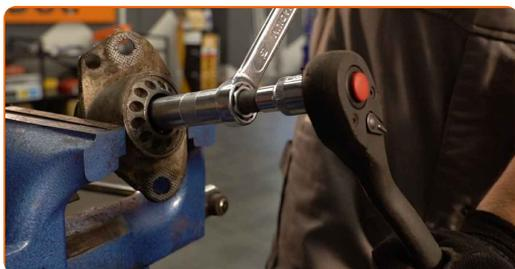
**16** Remova o suporte do amortecedor, a coifa e o batente de encosto do amortecedor.
