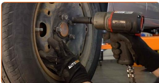
**34** Baixar o carro e trabalhar em ordem transversal, apertar os parafusos das rodas. Use uma chave de torque. Aperte-o para o torque de 120 Nm.
