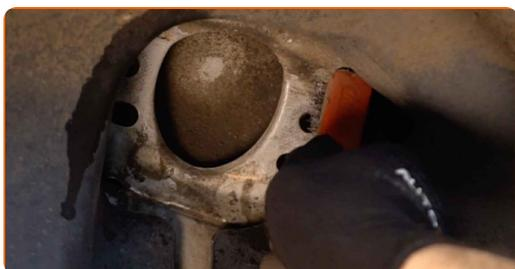
**20** Trate os assentos de montagem do amortecedor. Use massa de cobre.
