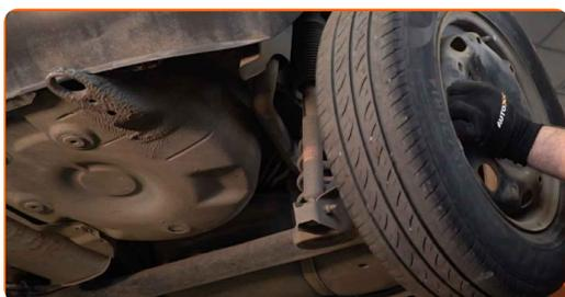
**6** Limpe os elementos de fixação do amortecedor. Use uma escova metálica. Use spray WD-40.
