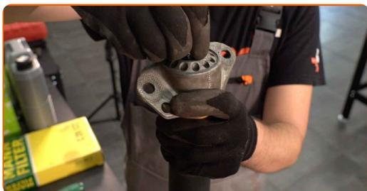
**18** Aperte a fixação superior da haste do amortecedor. Use uma chave soquete nº 15. Utilize a chave para amortecedor. Use uma chave de torque. Aperte-o para o torque de 25 Nm.
