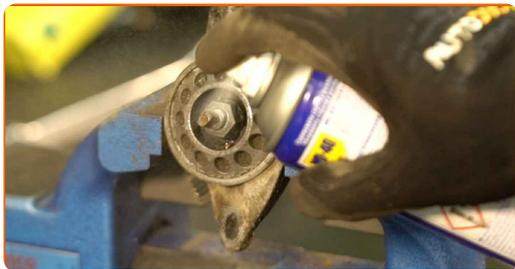
**15** Retire a fixação da haste do pistão do amortecedor. Use uma chave soquete nº 15. Use uma chave de catraca.
