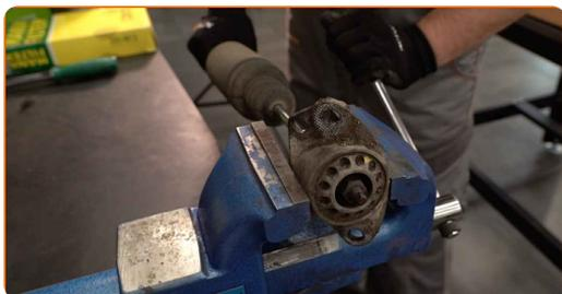
**14** Limpe o elemento de fixação de componentes do amortecedor. Use uma escova metálica. Use spray WD-40.
