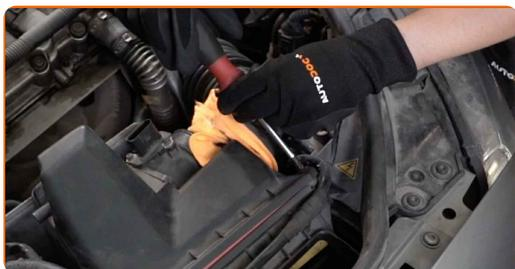
**10** Levante levemente a tampa da caixa do filtro de ar.
