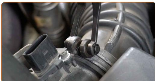
**19** Trate o conector do sensor de fluxo de massa de ar. Use graxa dielétrica.
