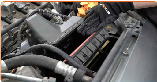
**11** Remova o elemento de filtro a partir da caixa do filtro.
