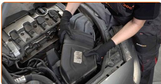
**22** Aparafuse os fixadores do conjunto da caixa de distribuição de ar. Use a chave Phillips.
