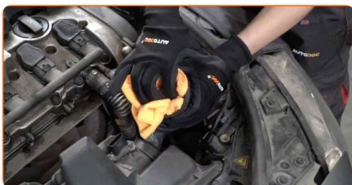
**9** Desaperte os parafusos de fixação da tampa do filtro de ar. Use a chave Phillips.
