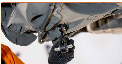
**12** Aperte o fixador que conecta a barra estabilizadora ao braço. Use uma chave soquete nº 13. Use uma chave de torque. Aperte-o para o torque de 25 Nm.
