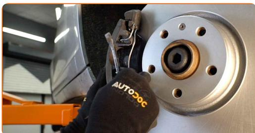
**23** Trate a superfície onde o disco de travão entra em contacto com o aro da roda. Use massa de cobre.
