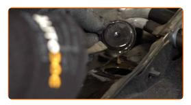
Solte o fixador superior do apoio da coluna de suspensão. Use uma chave soquete nº 16. Use uma chave de catraca.
