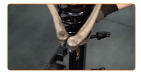
Instale o amortecedor no arco da roda.
