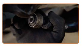
Aperte o fixador da bieleta da barra estabilizadora.
