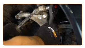
14 Remova o parafuso de fixação.
