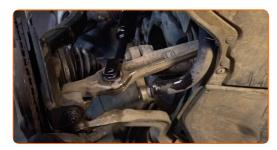
61 Instale o parafuso de fixação.
