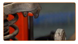
Desaparafuse os fixadores que ligam os braços de suspensão ao suporte do amortecedor. Use uma chave combinada nº 16. Use uma chave soquete nº 16. Use uma chave de catraca.
