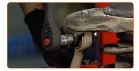
Remova o parafuso de fixação.
