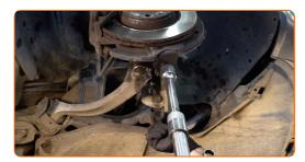
Aperte os parafusos do braço de suspensão superior (2 peças). Use uma chave combinada nº 18. Use uma chave soquete nº 18. Use uma chave de torque. Aperte-o para o torque de 45 Nm.
