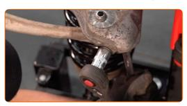
Aperte os fixadores que ligam os braços de suspensão ao suporte do amortecedor. Use uma chave combinada nº 16. Use uma chave soquete nº 16. Use uma chave de torque. Aperte-o para o torque de 50 Nm.+90°
