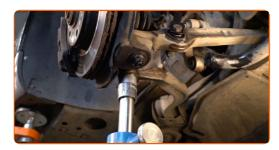
Trate todas as juntas do braço. Use um lubrificante multiusos. Use uma chave de fenda plana.
