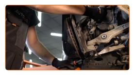
Desapertar a fixação superior de montagem do suporte do amortecedor. Use uma chave soquete nº 16. Use uma chave de catraca.
