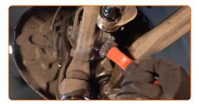
Desaperte a fixação inferior do suporte do amortecedor. Use uma chave combinada nº 18. Use uma chave soquete nº 18. Use uma chave de catraca.
