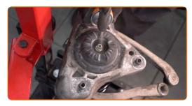
Retire a coluna de suspensão montada.
