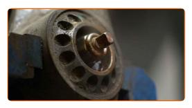
23 Instale a tampa protetora do suporte do amortecedor.
