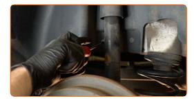
Apoie o eixo de torção da suspensão traseira. Use um macaco hidráulico de caixa de transmissão.
