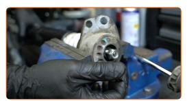
Aperte a fixação superior da haste do amortecedor. Utilize a chave para amortecedor DDNº6. Use uma chave soquete nº 16. Use uma chave de torque. Aperte-o para o torque de 25 Nm.
