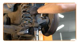
Substituição: amortecedor – SEAT IBIZA SPORTCOUPE Caixa/parte traseira inclinada (6J1). Conselho:
