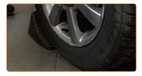
2 Solte os parafusos de montagem das rodas. Use o soquete de impacto para roda #17.
