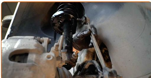
**Substituição: tirante da barra estabilizadora – SEAT IBIZA V (KJ1). Conselho de especialistas da AUTODOC:**
