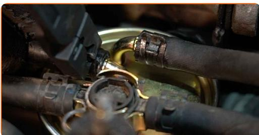
**20** Aperte as braçadeiras de fixação dos tubos do filtro de combustível. Use alicates de abraçadeira com retentor.
