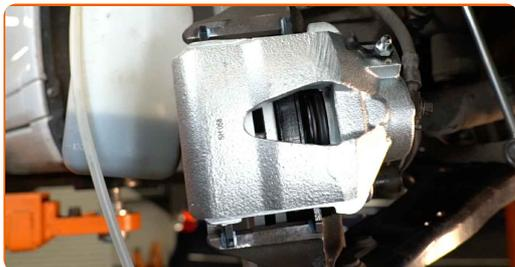
**27** Purgue o sistema da pinça de travão. Sem ligar o motor, pressione o pedal do travão várias vezes até sentir uma resistência significativa.
