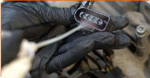
**9** Ligue os conectores das bobinas de ignição.
