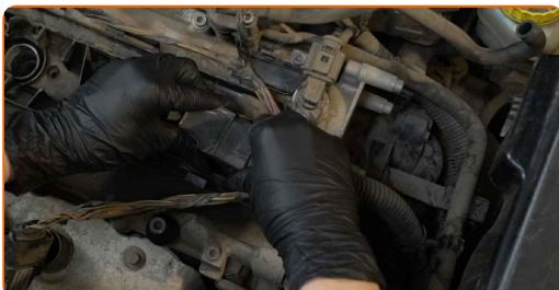
**10** Instale as bobinas de ignição nos poços das velas de ignição. Certifique-se que ouve um clique a indicar que está fixa no local.
