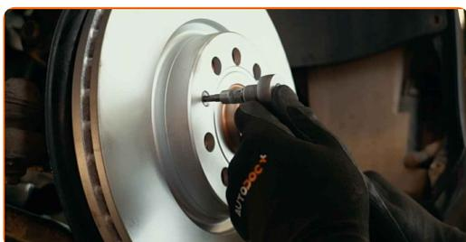
**25** Limpe a braçadeira da pinça de travão de sujidade e poeira. Use uma escova metálica. Utilize um produto de limpeza para travões.
