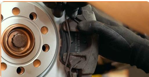
**34** Trate a superfície onde o disco de travão entra em contacto com o aro da roda. Use massa de cobre.
