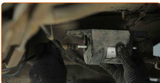
**10** Instale o novo filtro de combustível juntamente com o suporte.
