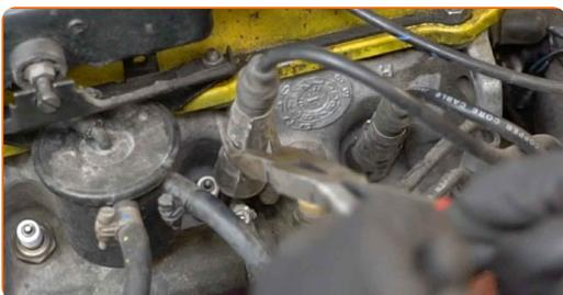
Substituição: vela de ignição – SEAT Ritmo (138). Conselho:
