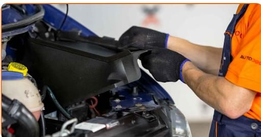
**4** Remova os retentores dos fixadores dos tubos do filtro de combustível. Use uma chave de fenda plana.
