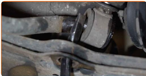
Substituição: tirante da barra estabilizadora – SEAT TOLEDO I (1L). AUTODOC recomenda:
