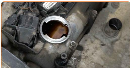
**25** Instale o tubo de enchimento de óleo. Aperte o tubo de enchimento de óleo.
