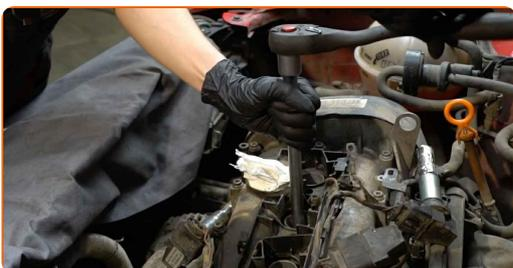
**15** Retire as velas de ignição. Use o soquete da vela de ignição #16.
