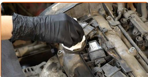
**9** Desaperte as abas de bloqueio plásticas do conector da bobina de ignição. Use uma chave de fenda plana.
