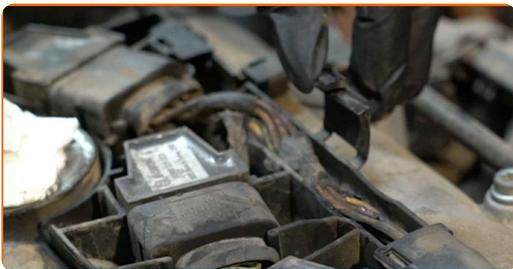
**10** Desaperte os fixadores do terminal de ligação à terra das bobinas de ignição. Use uma chave soquete n° 10. Use uma chave de catraca.
