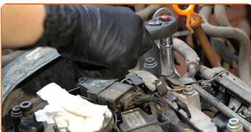
**11** Retire a bobina de ignição do orifício da vela de ignição. Utilize um pé-de-cabra.
