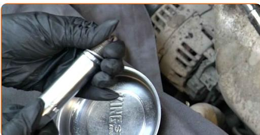
**16** Aplique uma fina camada de lubrificante especial na superfície da rosca das novas velas de ignição. Use massa de cobre.
