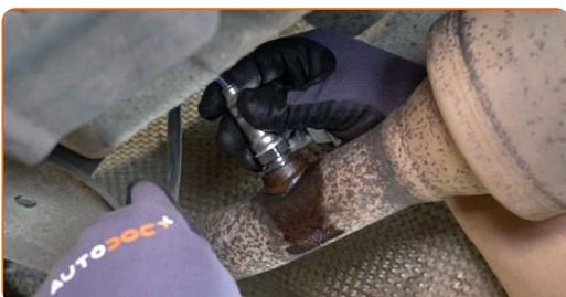
**14** Aperte o fixador do sensor de oxigênio. Utilize uma chave poligonal aberta #22. Use uma chave de torque. Aperte-o para o torque de 37 Nm.
