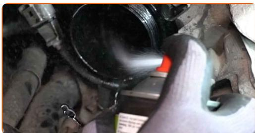
**19** Instale a nova tampa da caixa do filtro de óleo e aperte-a. Use uma chave soquete nº 36. Use uma chave de torque. Aperte-o para o torque de 25 Nm.
