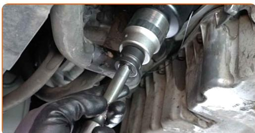
**20** Limpe a área do orifício de drenagem do cárter. Use o spray de limpeza universal.
