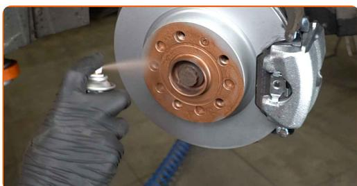
**30** Limpe a superfície do disco de travão. Utilize um produto de limpeza para travões.
