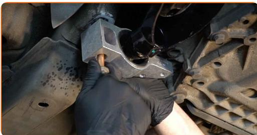
**18** Aperte o fixador traseiro que liga o braço da suspensão à carroçaria. Use uma chave combinada nº 18. Use uma chave soquete nº 18. Use uma chave de catraca.
