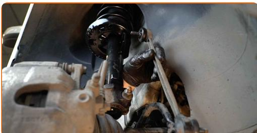
**Substituição: tirante da barra estabilizadora – SEAT Toledo IV Hatchback (KG3). Conselho de especialistas da AUTODOC:**
