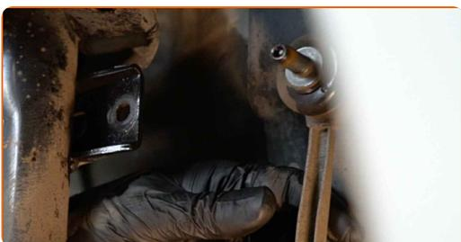
**16** Desligue a instalação elétrica e a mangueira do travão do braço de suporte do amortecedor. Utilize um pé-de-cabra.
