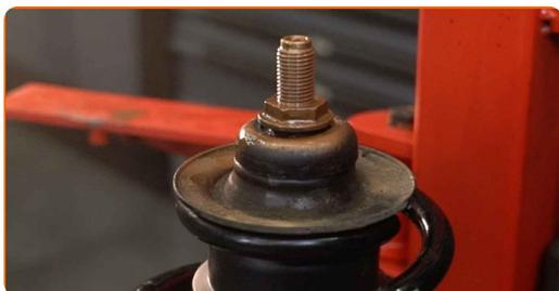
**48** Retire a coluna de suspensão montada.
