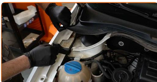
**5** Remova a tampa do apoio da coluna de suspensão.
