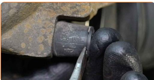
**10** Desaperte os parafusos da pinça de travão. Use HEX n.º H7. Use uma chave de catraca.
