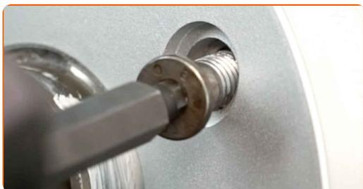
**25** Aperte a fixação do disco de travão. Use HEX n.º H6. Use uma chave de torque. Aperte-o para o torque de 10 Nm.
