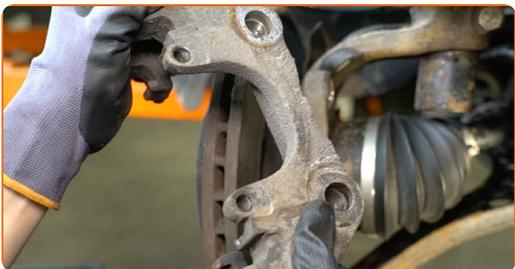
**17** Limpe o fixador do disco de travão. Use uma escova metálica. Use spray WD-40.
