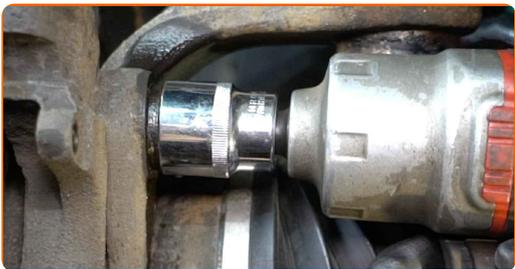
**15** Retire os parafusos de fixação.
