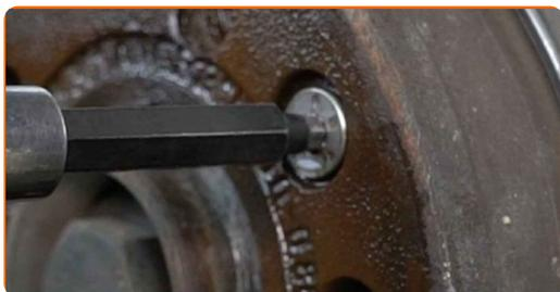
**19** Remova o parafuso de fixação.
