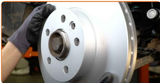
**24** Instale o parafuso de fixação.
