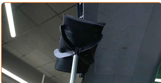
**3** Solte o anel de retenção que liga o amortecedor a gás à carroçaria do automóvel. Use uma chave de fenda plana.
