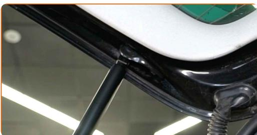
**15** Encaixe o anel de retenção que liga o amortecedor da bagageira à carroçaria do automóvel.
