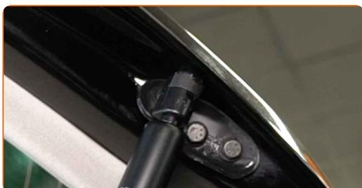
**12** Encaixe o anel de retenção que liga o amortecedor da bagageira à carroçaria do automóvel.
