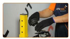
26 Instale o novo suporte superior do amortecedor.
