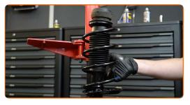
Instale o amortecedor no arco da roda.
