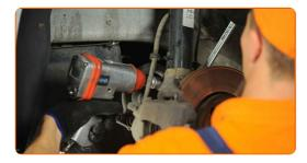
Remova o parafuso de fixação.
