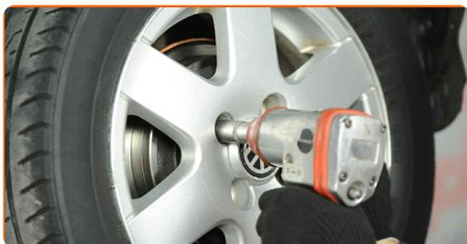
**16** Baixe o carro e trabalhar em ordem transversal, apertar os parafusos das rodas. Use o soquete de impacto para roda #17. Use uma chave de torque. Aperte-o para o torque de 110 Nm.
