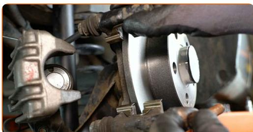
**28** Instale os parafusos de fixação.
