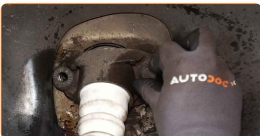
**27** Enrosque os parafusos do apoio do amortecedor. Use uma chave soquete nº 16. Use uma chave de catraca.
