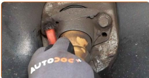
**11** Desaperte os parafusos do apoio do amortecedor. Use uma chave soquete nº 16. Use uma chave de catraca.
