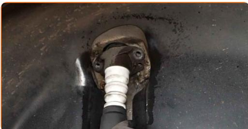
**26** Instale os parafusos de fixação.
