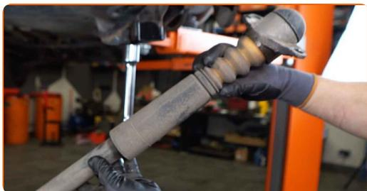
**14** Limpe os locais de montagem do amortecedor. Use uma escova metálica. Use spray WD-40.
